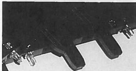
**Links ein unbearbeiteter Kontakt und zwei weitere mit leicht aufgebogenen Kontaktfahnen. Zur Demonstration ist unten ein Kupferdraht in Bahnstücke eingeschoben.**
